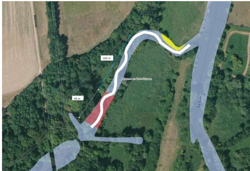
Figure 34 : Principe d'aménagement retenu
